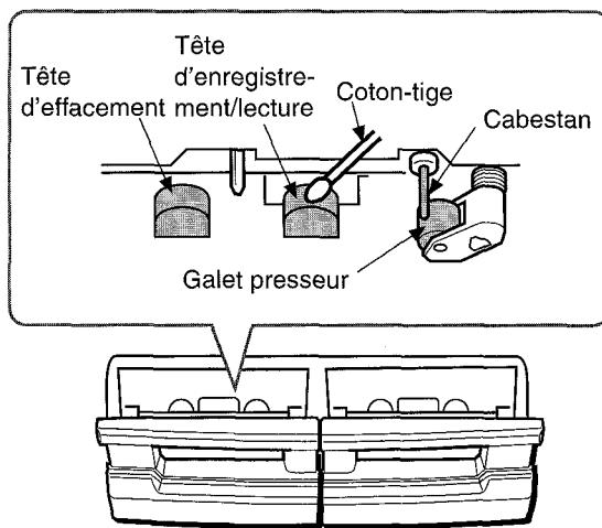
Après le nettoyage des têtes et du passage de la bande avec une cassette de nettoyage de têtes de type humide ou avec un coton-tige imbibé, attendez que les parties nettoyées soient complètement sèches avant de mettre les cassettes en place.
